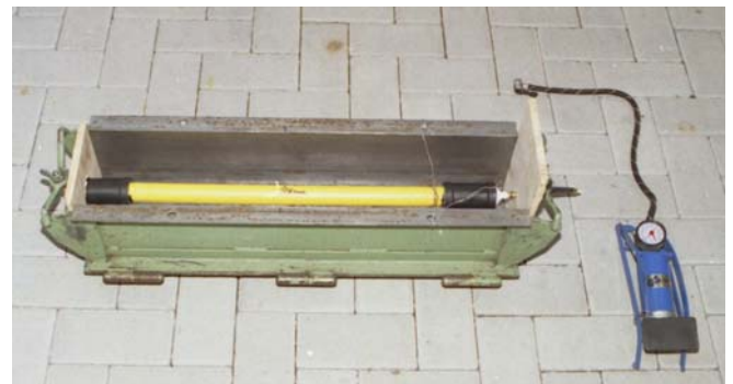
Bild 2. Versuchsanordnung der Permeabilitätsmessungen des FITR.
