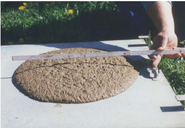
Bild 1. Ermittlung des sog. Ausbreitmaßes zur Feststellung der Fließfähigkeit von Boden-Mörtel.
