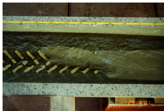
Bild 2: Strukturierter Bereich einer 25 langen Betonrohrversuchsstrecke DN 400 (links), Abtrag von Sediment – der Pfeil kennzeichnet die Strömungsrichtung (rechts)
