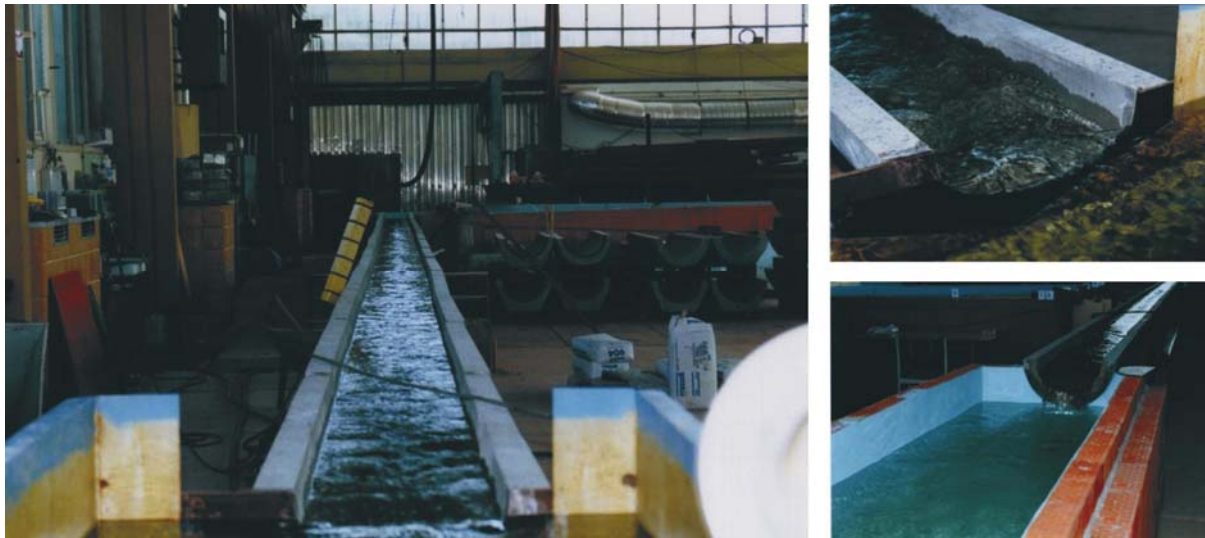
Abb. 9: Betonrinne des FITR im Hydrolabor Schleusingen der BUW (links: Gesamtansicht; rechts oben: Zulauf; rechts unten: Ablauf) [10]
