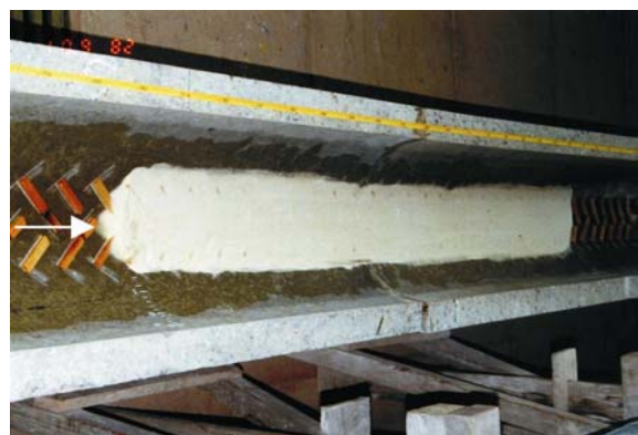
Abb. 11: Sandschicht vom 10. bis 12. Meter (der Pfeil kennzeichnet die Strömungsrichtung) [11]
