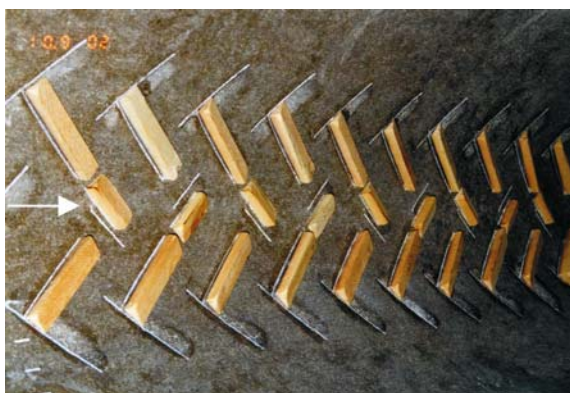
Abb. 10: Anordnung 2 der keilförmigen Strukturkörper (der Pfeil kennzeichnet die Strömungsrichtung) [10]
