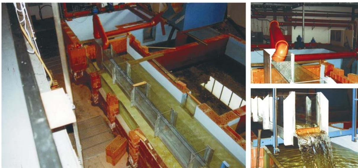
Abb. 4: Versuchsrinne im Hydrolabor Schleusingen der Bauhaus-Universität Weimar (links: Gesamtansicht der Rinne; rechts oben: Zulauf; rechts unten: Ablauf) [2, 6]
