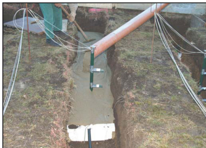
Versuchsstrecke mit Blähglas als Zuschlagstoff
