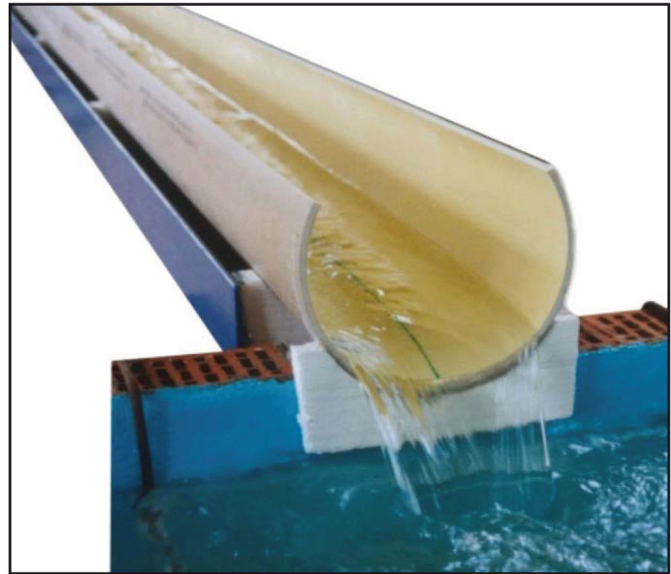
Versuchsrinne aus 2/3 GFK-Rohrschalen mit Ablaufbecken
