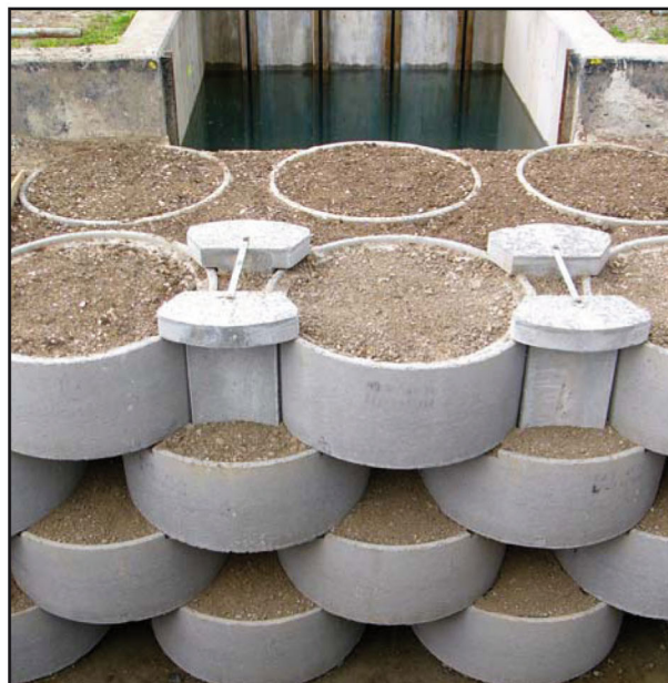
Doppelreihiges Abdichtungswandsystem in der Erprobungsphase
