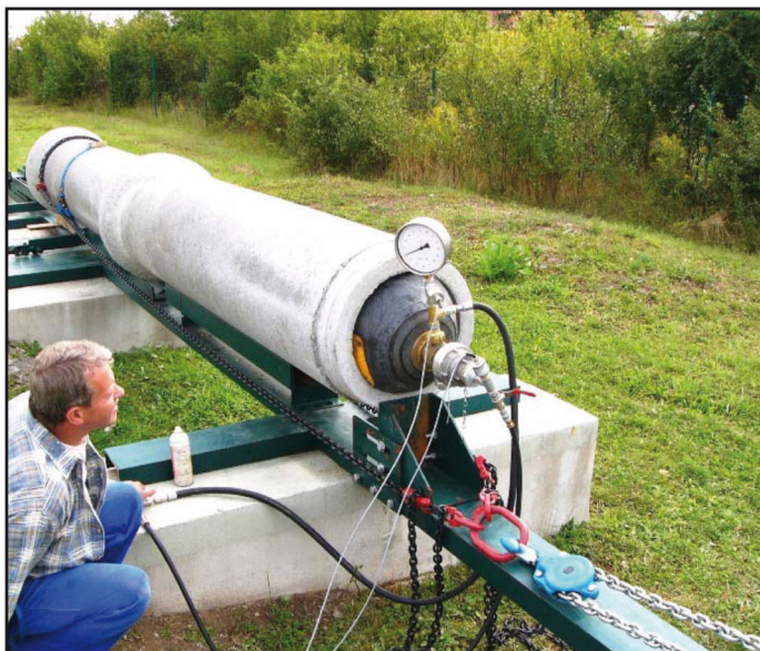
Versuchsstand für Aktivierungs- und Dichtungsüberprüfung
