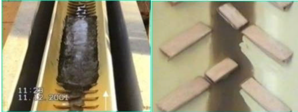
Keilförmige Strukturkörper (links), Sedimentationsmaterial – der Pfeil kennzeichnet die Strömungsrichtung (rechts)
