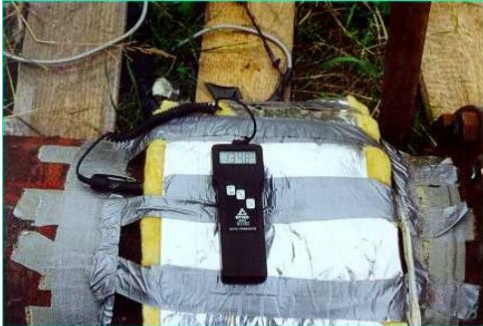
Isolierung des Temperatursensors an der Ablaufseite, Kontrolle der Temperatur mittels digitalem Thermometer
