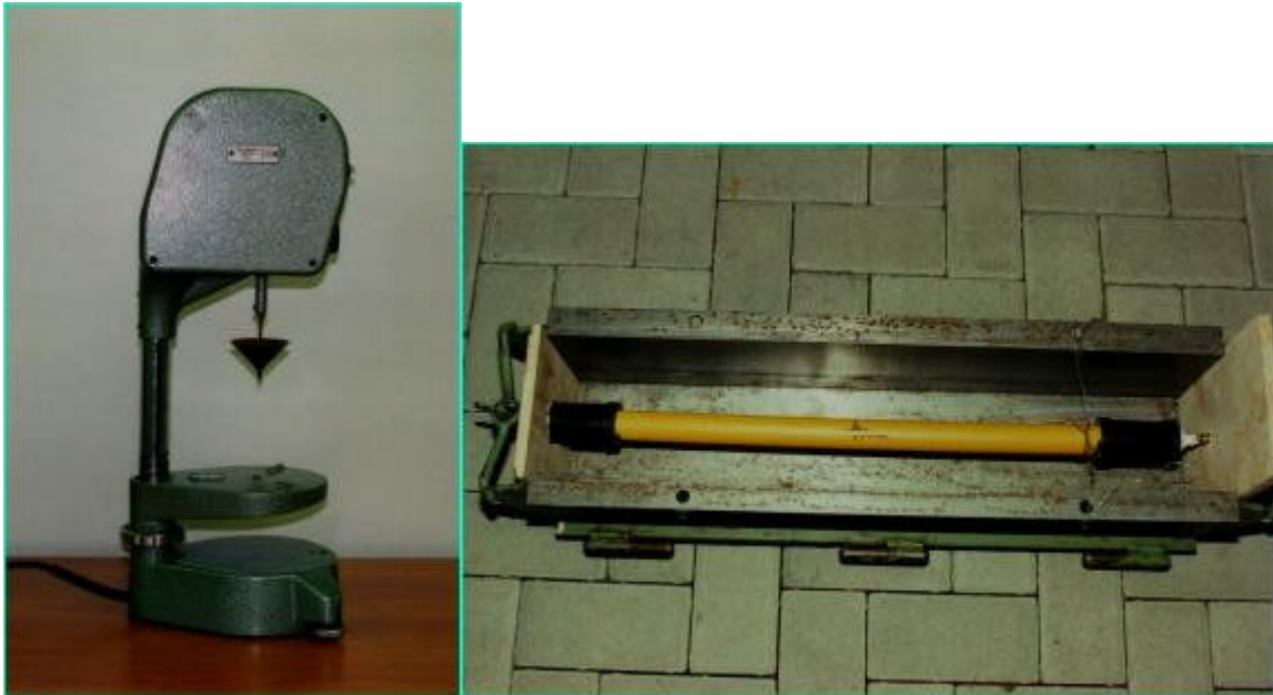
Penetrometer zur Bestimmung der Verfestigungseigenschaften (links), Versuchsstand zur Untersuchung des Gasdurchlässigkeitsverhaltens (rechts)
