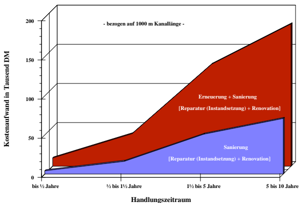
Bild 1: Prognose zum Finanzbedarf der Kommunen mit 2 bis 10 TEW für Instandhaltungsmaßnahmen im Abwassernetz
