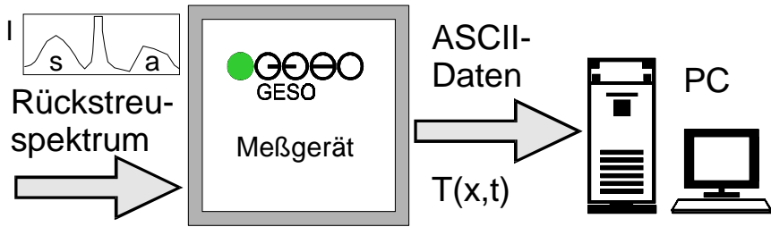
Bild 1: Schematische Darstellung des faseroptischen GESO-Leckwarn- und -ortungssystems nach [1]
