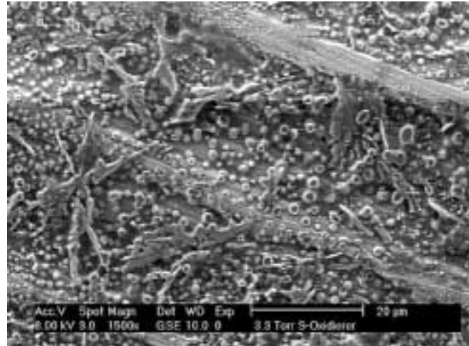
Bild 5: Besiedlung schwefelsäureoxidierender Bakterien auf PCC-Oberflächen
