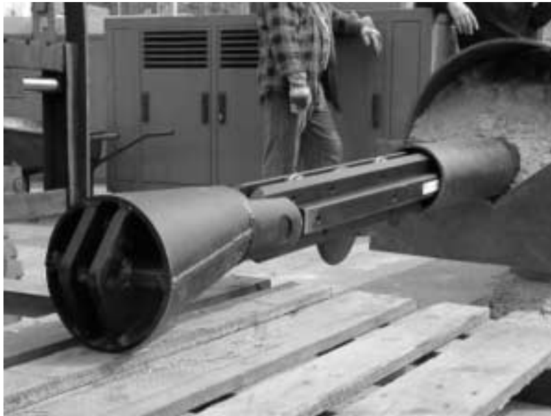
Bild 8: Der hydros ® STEEL-Schneidkopf während der Testphase an einem speziell entwickelten Versuchsstand
