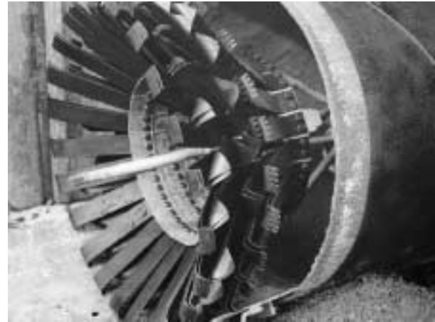
Bild 1: Inkrustationen in einer Wasserleitung Bild 2: Kratzmolch zur Reinigung von inkrustierten Leitungen
