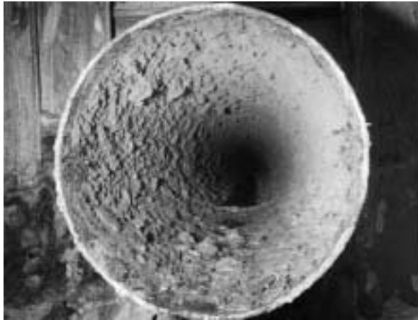
Bild 1: Inkrustationen in einer Wasserleitung Bild 2: Kratzmolch zur Reinigung von inkrustierten Leitungen
