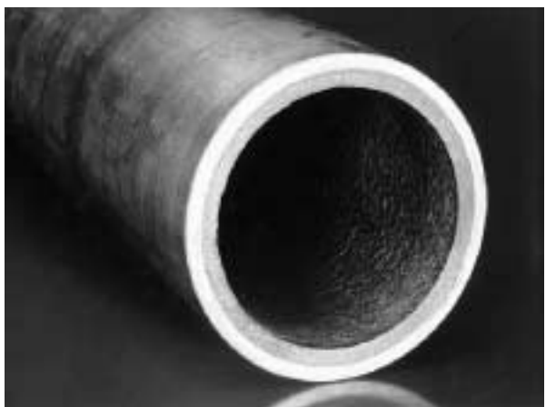
Bild 6: Mit Zementmörtelauskleidung sanierte Rohrleitung
