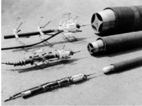
Bild 3: ZM-Anschleudermaschine für nicht-begehbare Leitungen
