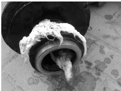
Bild 2: Störungsbild – falscher Einsatzbereich – zu großer Druckunterschied zwischen dem Druck- und Saugstutzen – Liefer- grad
